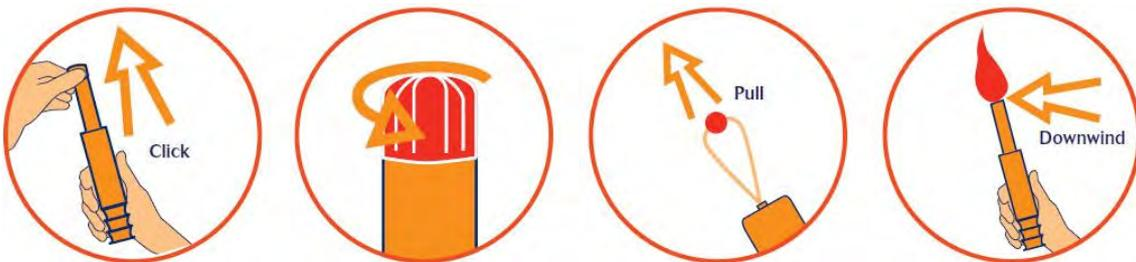
1. Estirar del extremo rojo hasta que el tubo telescópico esté totalmente extendido.
